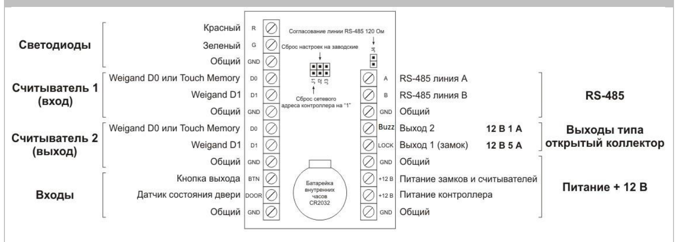
Рис. 1. Обозначения разъемов сетевого модуля контроля доступа iBC-01 Light
