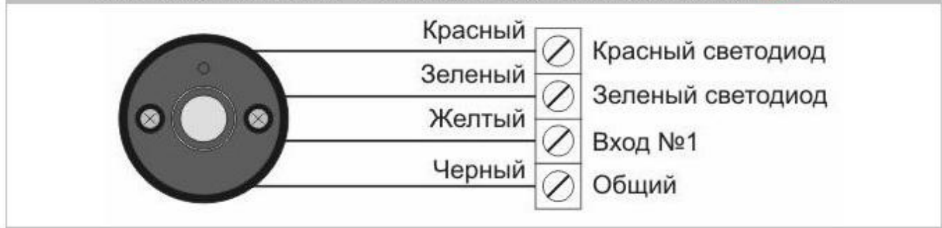
Рис. 4. Схема подключения считывателя ключей iButton (TouchMemory) iBR-XX
