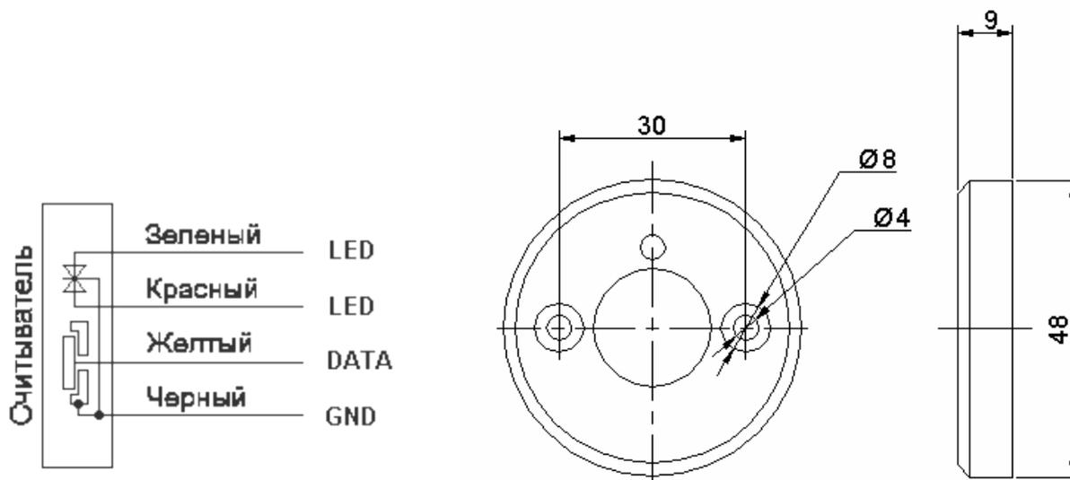
\* Производитель оставляет за собой право изменить цвет проводов. В этом случае распиновку можно определить с помощью тестера согласно вышеприведенной схеме.
